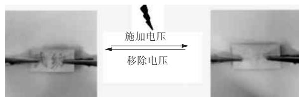
图4 PG-纸在 $4\text{V}$ 外加电压下的变色效应
